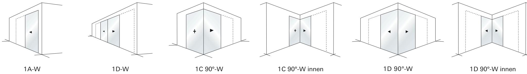
SCHIEBEELEMENTE MIT 2 LAUFSCHIENEN
