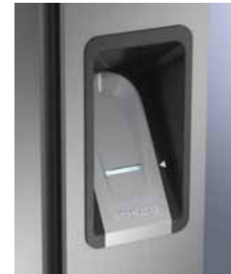
Accès par reconnaissance digitale
